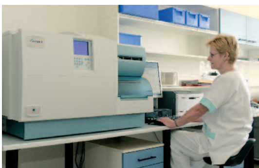
Automatický systém VITEK 2 ke stanovení citlivosti k antimikrobiálním látkám.
