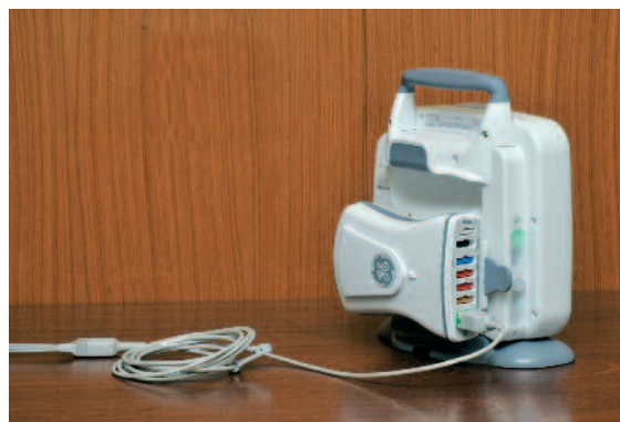
Transportní monitory Transport Pro GE Healthcare slouží k zachování kontinuálního monitorování akutních pacientů kardiochirurgického oddělení během převozů. Základní multiparametrický modul je společný pro monitorovací systém operačních sálů a intenzivní péče a umožní sledování vitálních funkcí bez ztráty dat a nutnosti přepojování.
