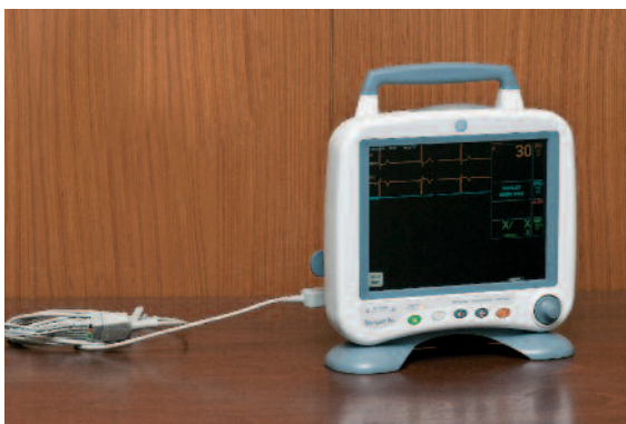
Transportní monitory Transport Pro GE Healthcare slouží k zachování kontinuálního monitorování akutních pacientů kardiochirurgického oddělení během převozů. Základní multiparametrický modul je společný pro monitorovací systém operačních sálů a intenzivní péče a umožní sledování vitálních funkcí bez ztráty dat a nutnosti přepojování.
